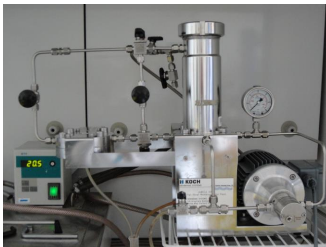
Rysunek 16 Fotografia instalacji laboratoryjnej do prowadzenia filtracji membranowej KMS Cell CF1 firmy KOCH Membrane Systems
