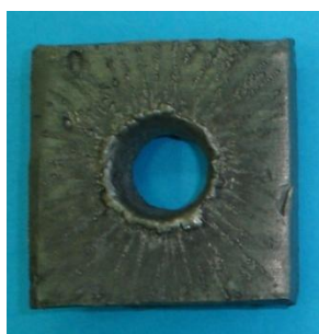
Fot. 2. Płytkę ołowianą przebita standardowym zapalnikiem skalnym, natychmiastowym
