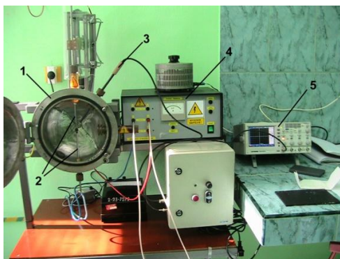
Fot. 1. Stanowisko badawcze do wyznaczenia wrażliwości na elektryczność statyczną. 1. Komora strzałowa, 2. Elektrody, 3. Fotodetektor, 4. Generator iskry, 5. Oscyloskop
