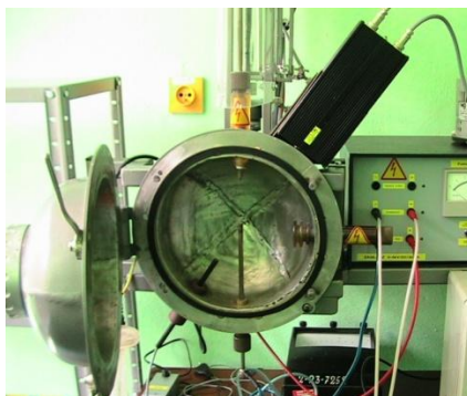
Fot. 6. Komora strzałowa do badania wrażliwości na promieniowanie laserowe
