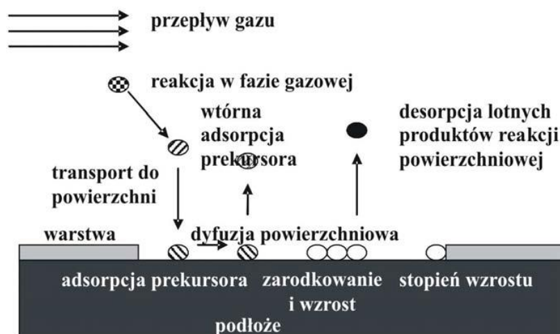
Rysunek 4. Schemat wzrostu warstwy w metodzie CVD [80]
