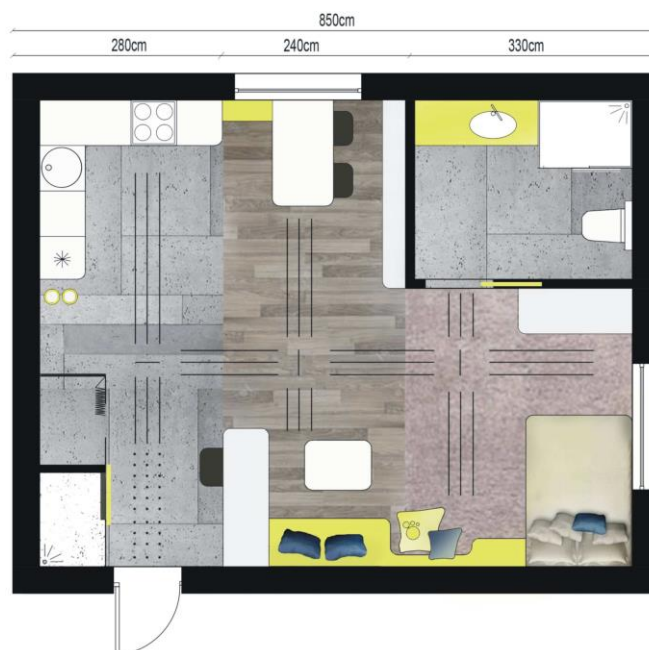
Rys. 3. Propozycja rozwiązania wnętrza mieszkania dla osoby słabo widzącej i niewidomej – układ na planie scentralizowanym.
