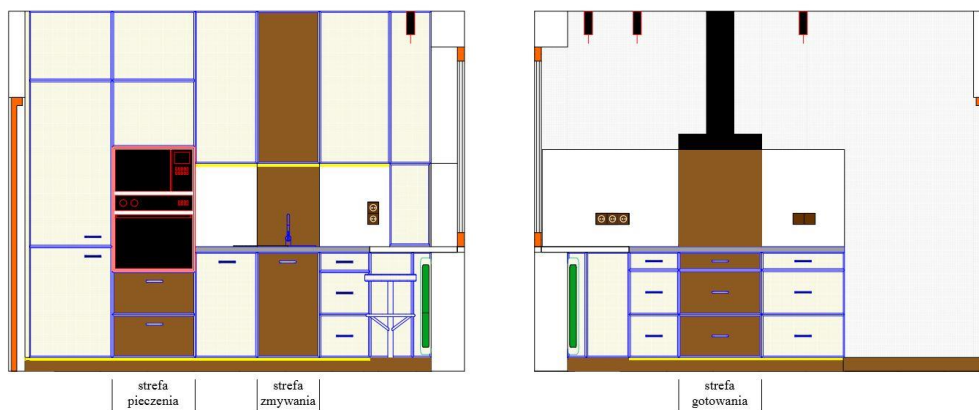
Rys. 7. Projekt kuchni – kłady ścian z meblami kuchennymi z podkreśloną kolorystycznie i fakturowo strefą gorącą (pieczenia i gotowania) oraz strefą mokrą (zmywania).
