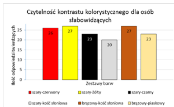
Rys. 3. Wyniki badań nad czytelnością kontrastu wśród osób z dysfunkcją wzroku.
