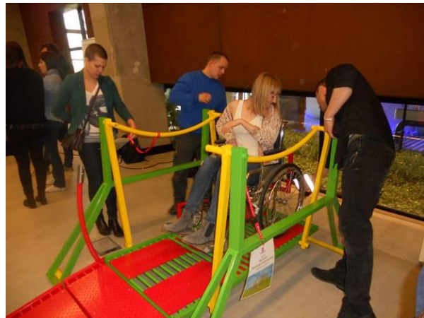
Rys. 3. Testowanie huśtawki dla osób poruszających się na wózku.
