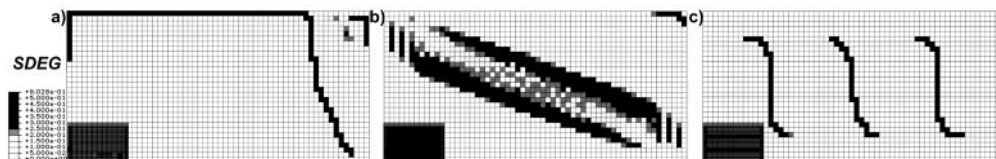
Rys. 2. Zmiana mechanizmu zniszczenia przy: a) braku wzmocnienia, b) wzmocnienia całej powierzchni muru, c) wzmocnienie dwoma pasami poziomymi.
