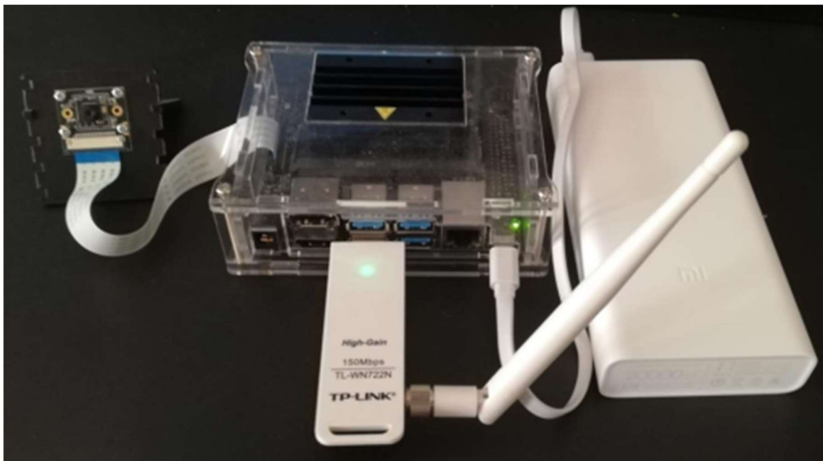
Rys. 11 Urządzenie IoT działające w oparciu o komputer NVidia Jetson Nano w wersji 2GB [110]
