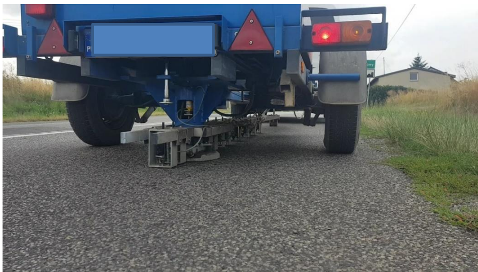
Rysunek 6.3 Płyta obciążeniowa oraz geofony na urządzeniu FWD (mat. własne)
