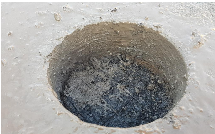
Rysunek 6.13 Odwiert kontrolny w pasie wzmocnionym ukazujący siatkę z włókna szklanego (mat. własny)
