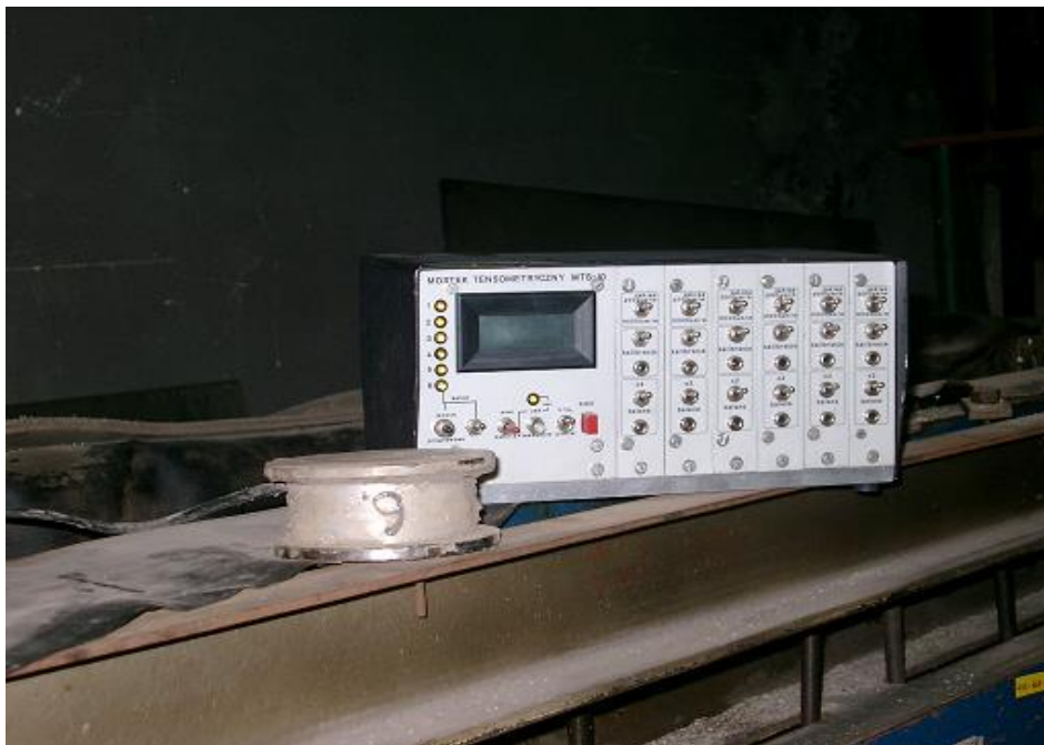
Rysunek 5.5 Zdjęcie mostka MTS-10 wraz z czujnikiem (Kotasiński, 2004)
