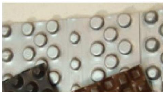
Rysunek 4.8 Przykład geosyntetyku przestrzennego (Hufenus, 2002; IBDiM, 2003)
