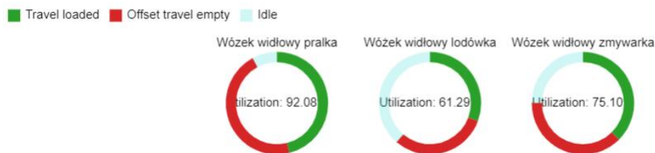
Rysunek 10. Wykres rozkładu czynności w procesie ładowania pojazdu ciężarowego przez wózki widłowe Źródło: [Opracowanie własne na podstawie programu FlexSim]
