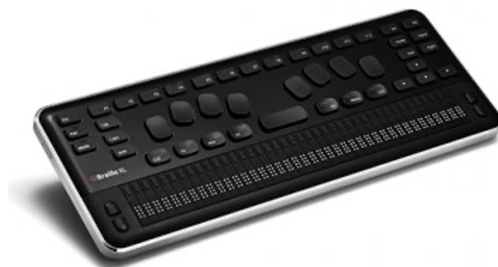
Rys. 9.5 Przykład monitora brajlowskiego [4]
