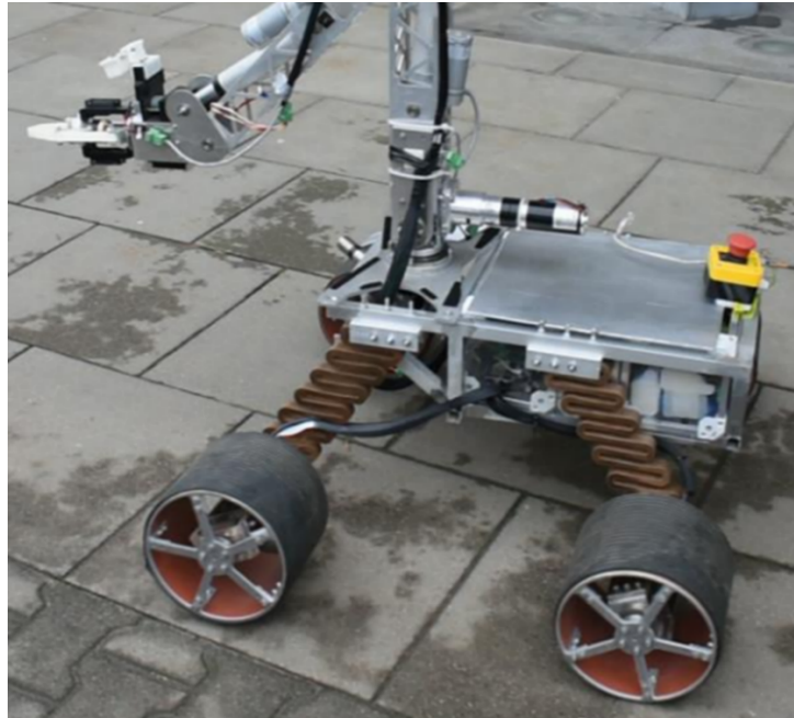
Rys. 3.3 Koła z sztywnymi szprychami oraz pokryciem wykonanym TPU [6]
