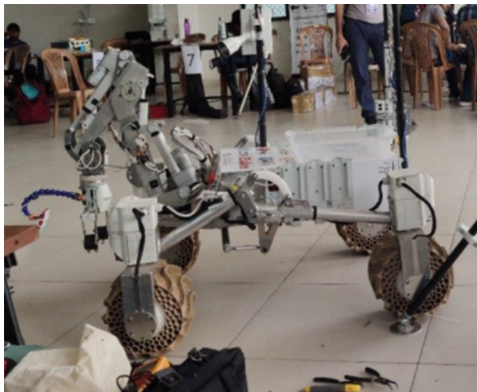
Rys. 3.4 Elastyczne koła wykonane tylko z wykorzystaniem technologii FDM [7]
