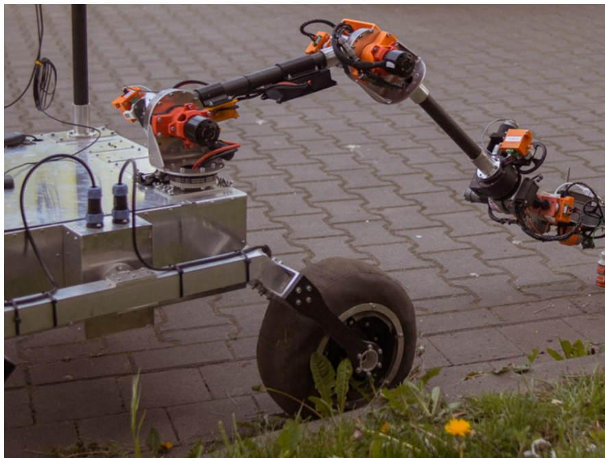
Rys. 3.2 Bezpowietrzna opona z tkaniny Cordur wypychana gąbką [5]
