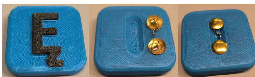
Rys. 7.10 Budowa kostki do urządzenia Rzep CHECK
