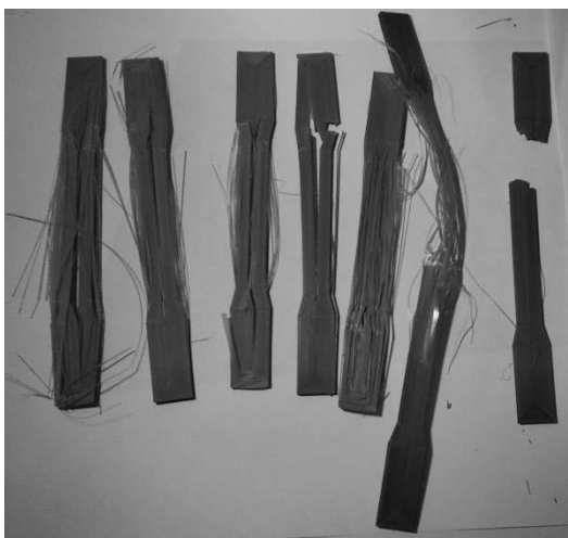
Rys. 2. Przykłady typów zniszczeń próbek Fig.2 Examples of specimen damage
