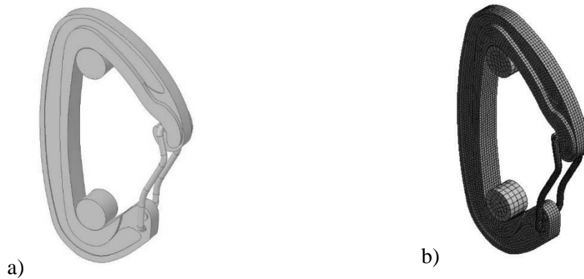
Rys. 1. Model karabinka: a) geometria opracowana za pomocą programu SpaceClaim, b) siatka elementów skończonych
