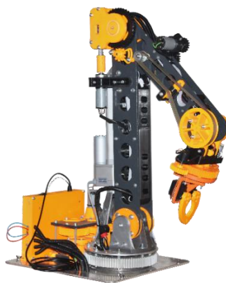
Rys. 1. Zmodernizowany prototyp manipulatora Fig. 1. Modernized manipulator prototype
