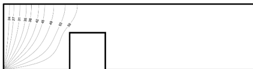
Rys. 2. Rozkład temperatury po czasie 4 sekund – krok czasu 0.00001 s Fig. 2. Temperature distribution after 4 seconds – time step 0.00001 s
