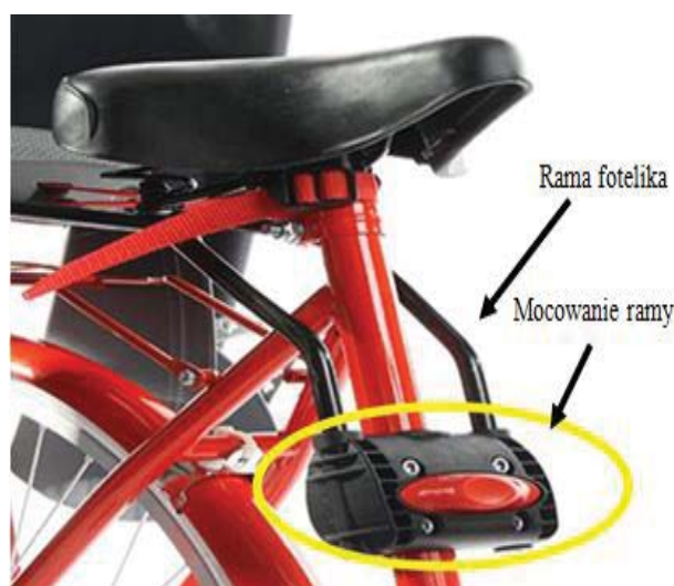
Rys. 1. Mocowanie fotelika Polisport Boodie FF [3]
