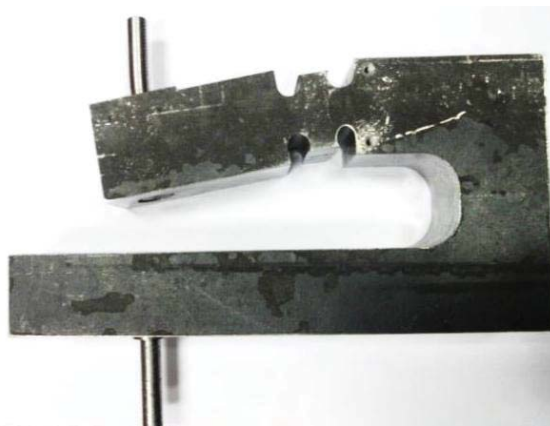
Rys. 3. Belka tensometryczna po odkształceniu
