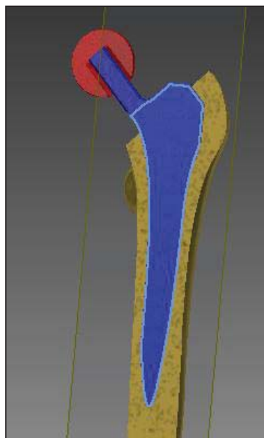
Rys. 5. Przekrój układu kość-implant z programu Autodesk Inventor
