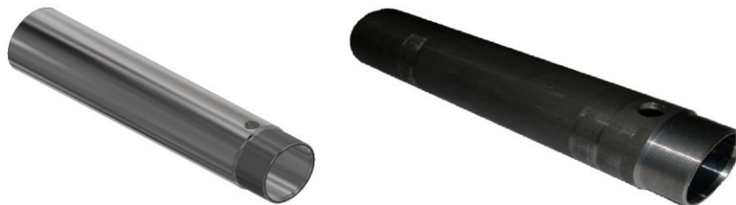
Rys. 3. Model CAD oraz model fizyczny rury cylindra
