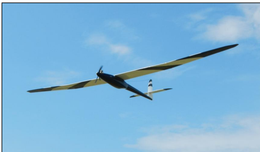
Rys. 7. Testy spalinowego motoszybowca „Orzeł” z kamerą cyfrową na pokładzie (moment wyjścia z lotu nurkowego z prędkością około 60 km/h) widać lekkie ugięcie skrzydła w sekcji centropłata w którym zastosowano nowo opracowany typ dźwigara [7]
