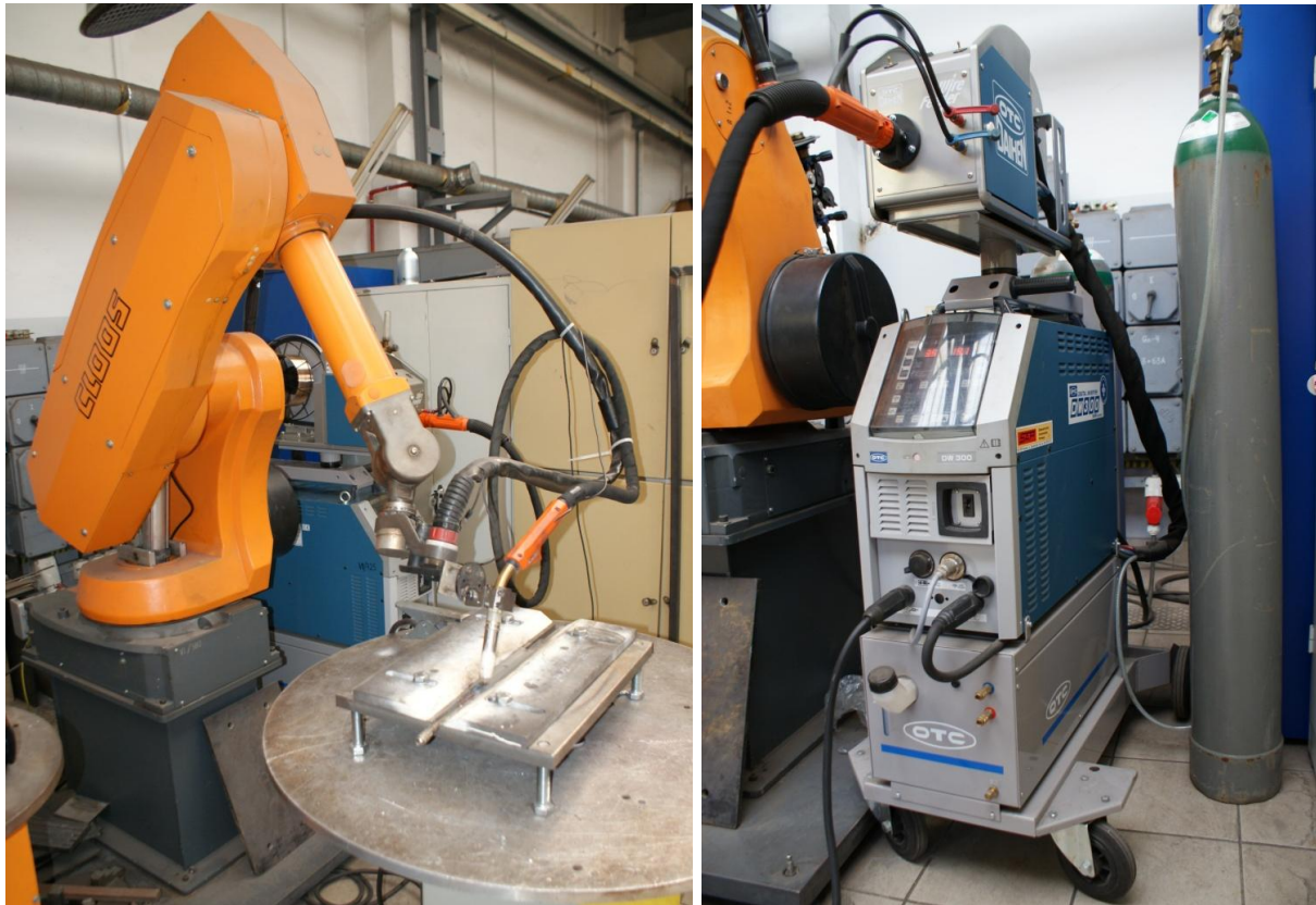
Rys. 2. Zdjęcie stanowiska do wykonywania prób lutowania (z lewej) i zastosowanego urządzenia spawalniczego (z prawej)
