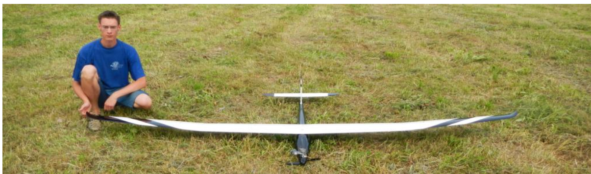
Rys. 1. Motoszybowiec spalinowy „Orzeł” z omawianym w pracy skrzydłem z kompozytów
