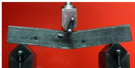
Rys. 5. Test wytrzymałości wzmocnionego dźwigara
