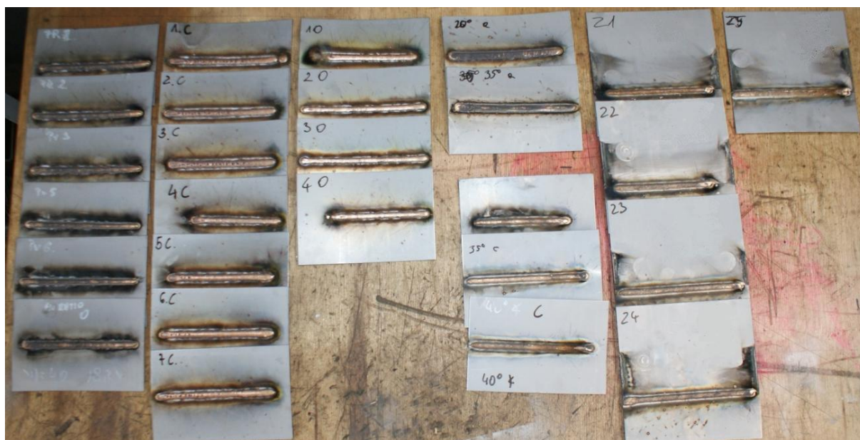
Rys. 3. Lutonapoiny i lutowoiny w złączu zakładkowym wykonane w badaniach wstępnych
