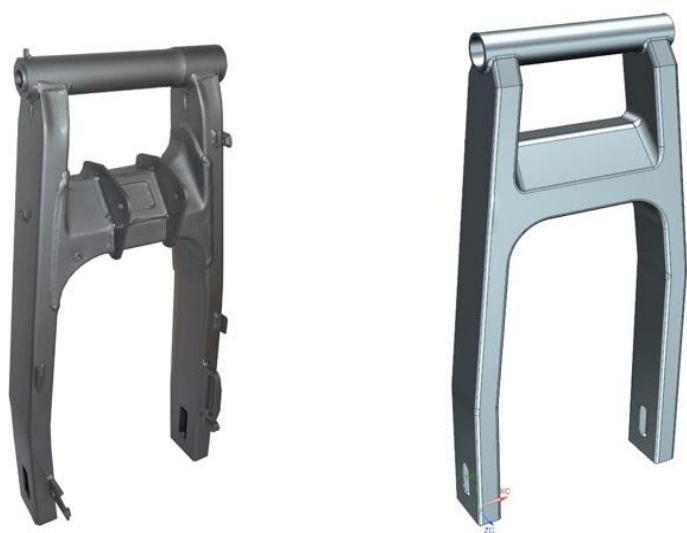
Rys. 1. Rzeczywisty wahacz i uproszczony model CAD
