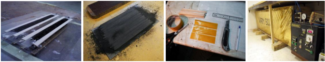
Rys. 2. Wykonywanie próbek z różnych rodzajów włókien węglowych
