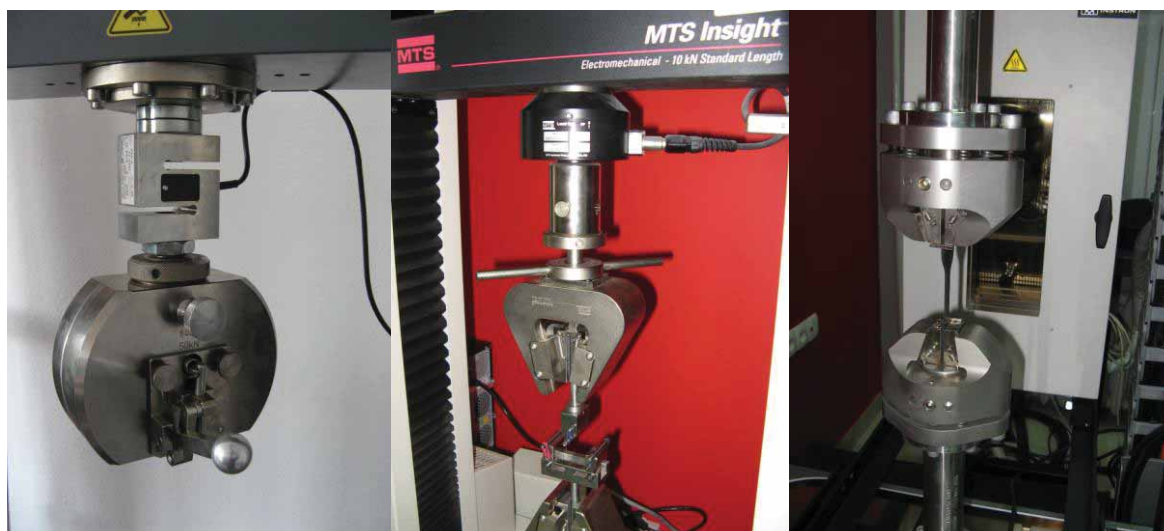
Rys. 2. Sposoby zamocowania uchwytów w maszynach: Zwick, MTS, Intron
