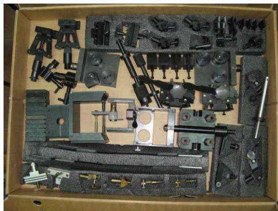
Rys. 1. Komplet oprzyrządowania maszyny wytrzymałościowej Heckert FPZ 100/1 ®
