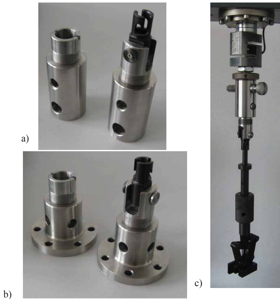
Rys. 4. Komplet adapterów: a) dla maszyny Zwick Z050, b) dla maszyny Intron Electropuls E10000, c) samozaciskowe szczęki zamocowane na maszynie Zwick Z050
