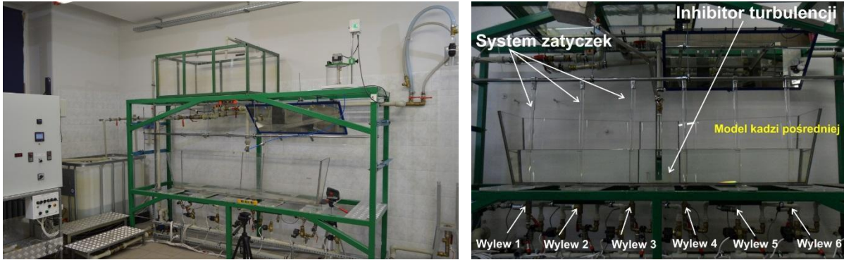
Rys. 2.34. Widok modelu urządzenia do ciągłego odlewania stali
