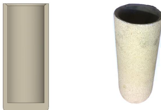
Rys. 3.10. Tygiel ceramiczny wykorzystany w PIT
