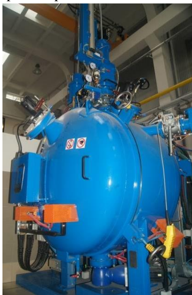
Rys. 3.7. Stanowisko badawcze PIT: 1 - komora próżniowa, 2 - tygiel, 3 - cewka indukcyjna chłodzona wodą, 4 - mechanizm przechyłu tygla, 5 - drzwi pieca, 6 - układ pomp próżniowych, 7 - generator, 8 - układ poboru próbek i pomiaru temperatury, 9 - sterowanie przechyłem tygla, 10 - panel operatorski, 11 - wziernik, 12 - wlewnica (forma), 13 - grzejnik formy, 14 - szafa sterująca, 15 - układ wprowadzania dodatków stopowych, 16 - podest operatorski
