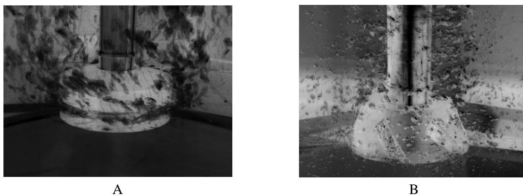
Rys. 2.54. Przykładowe wyniki generowanych pęcherzyków gazowych otrzymanych w ramach badań wizualizacji stopnia dyspersji dla reaktora URO-200 dla wirnika: A) nr 2, B) nr 3
