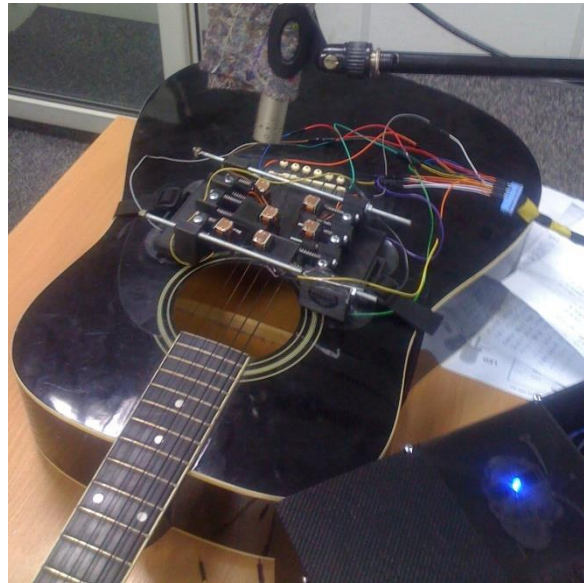
Fig. 3. Eddie, a guitar playing robot mounted on an acoustic guitar Rys. 3. Robot Eddie zamontowany na gitarze akustycznej
