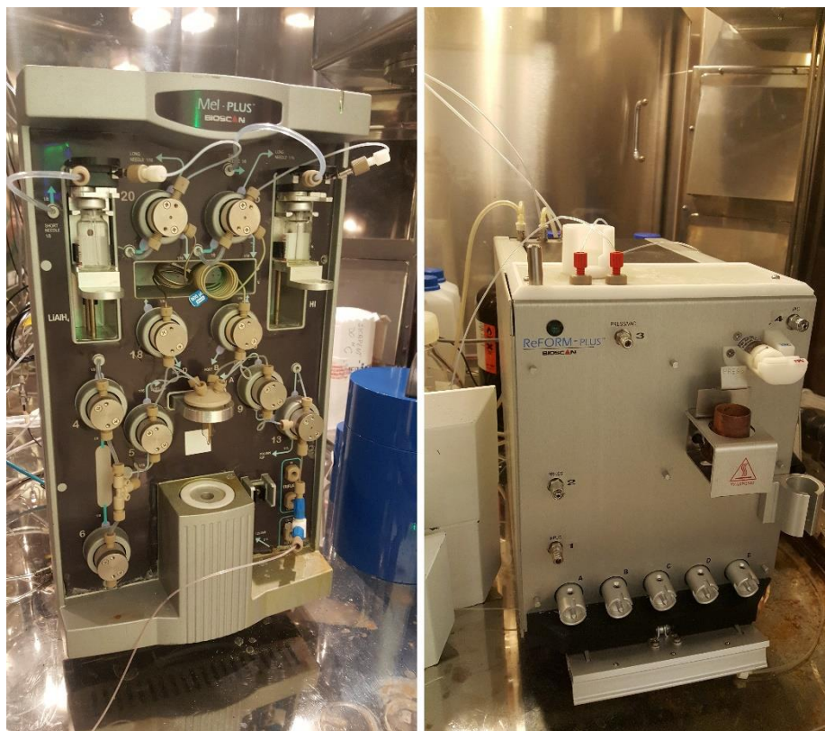
Rysunek 6.2. Zestaw modułów firmy Bioscan składający się z modułu Mel+ (po lewej) służącego do syntezy [^{11}\text{C}]\text{-CH}_3\text{I} ; oraz modułu ReFORM+ (po prawej), w którym następuje przyłączenie grupy metylowej znakowanej węglem-11 do cząsteczki prekursora.
