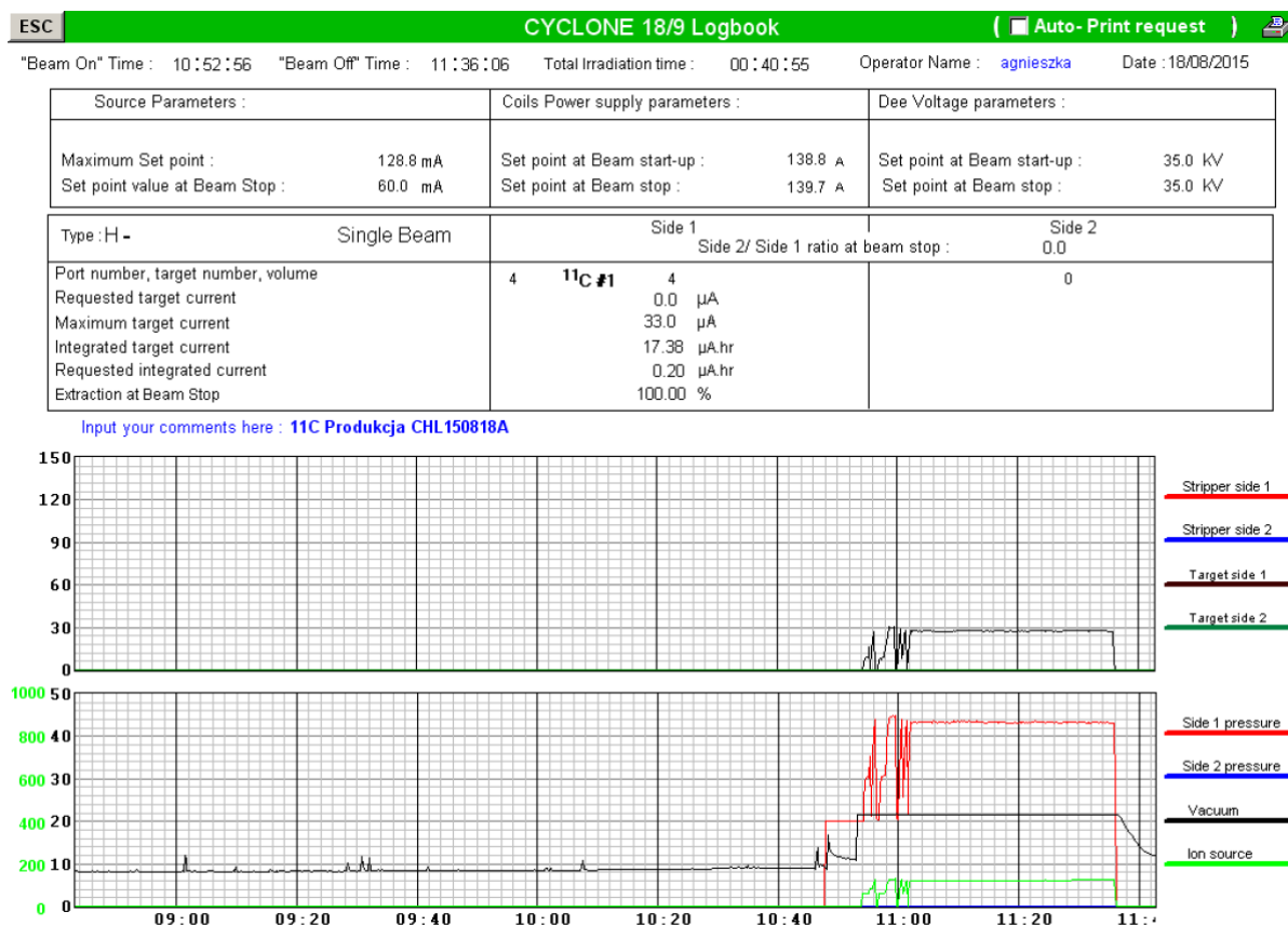
Rysunek 9.2. Raport serii z wytwarzania izotopu węgla-11. Górny wykres przedstawia natężenie wiązki padającej na tarczę w czasie napromieniania. Dolny wykres przedstawia ciśnienie w tarczy (linia czerwona), natężenie prądu w łuku elektrycznym źródła (linia zielona) oraz wartość próżni utrzymywanej w cyklotronie (linia czarna).
