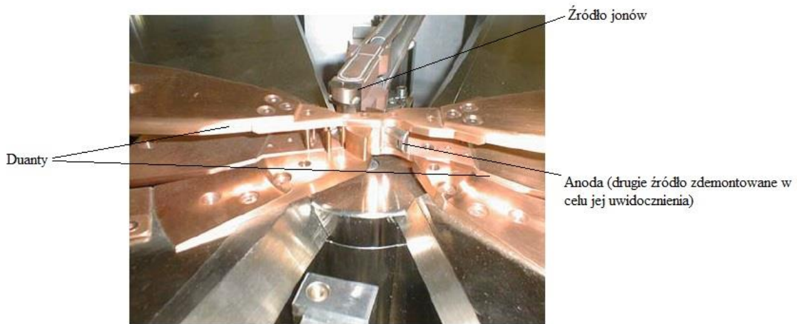
Rysunek 6.8. Region centralny cyklotronu IBA Cyclone 18/9.
