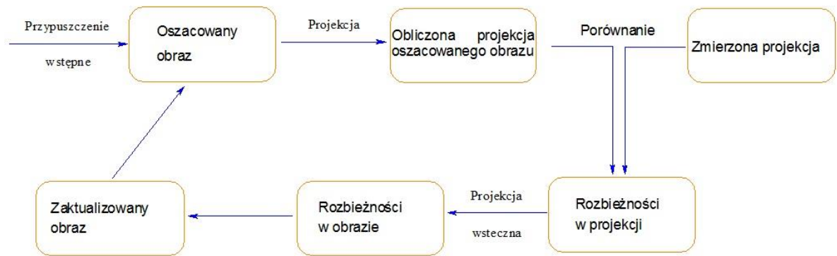
Rysunek 3.15. Schemat blokowy iteracyjnych metod rekonstrukcji obrazu.
