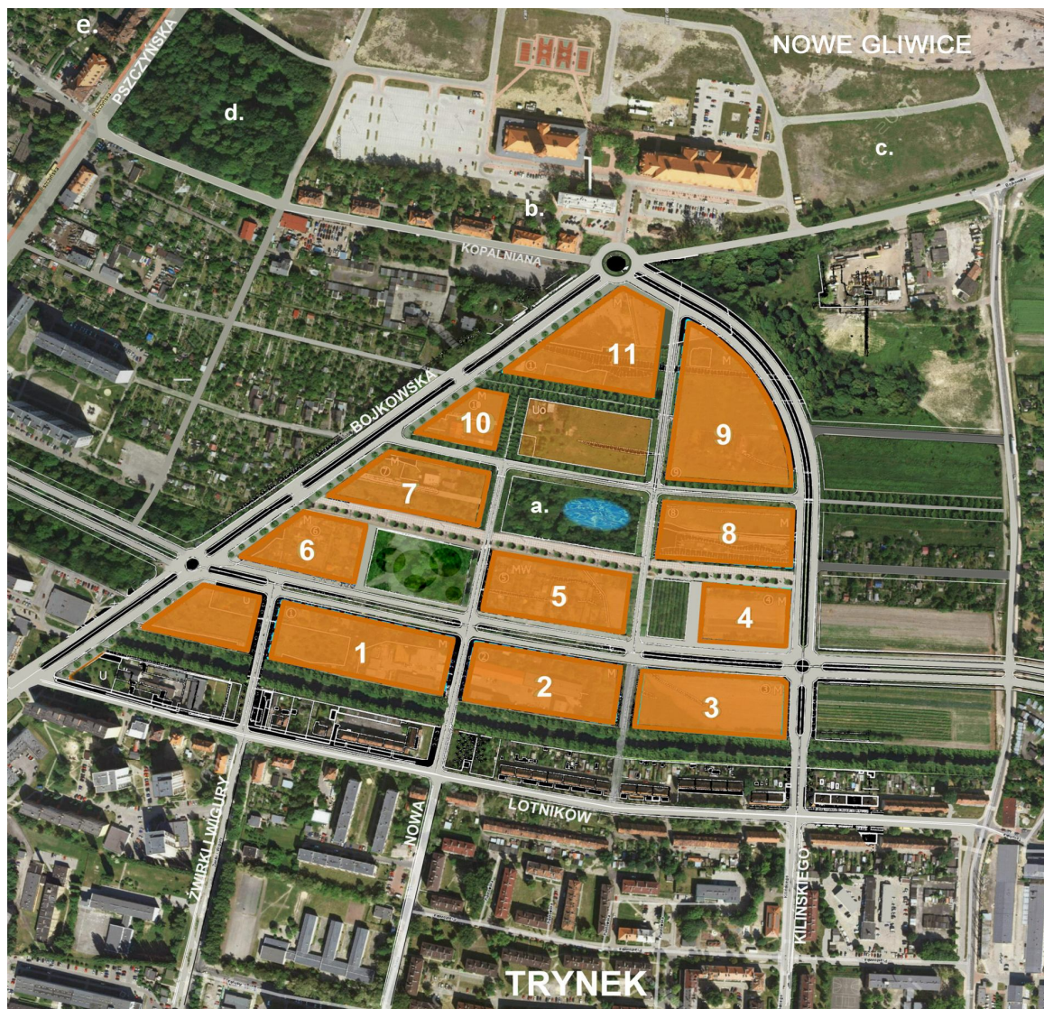
Ryc.3 Plan regulacyjny nowego centrum dzielnicowego między Strefą aktywności gospodarczej Nowe Gliwice a Trynkiem. 1-11: kwartały zabudowy wg planu regulacyjnego (nieprzekraczalne linie zabudowy), proj. Jerzy Witeczek 2008, a. plac centralny nowego zespołu mieszkaniowego z parcelą na funkcję usługową od północy, b. „Nowe Gliwice” – Centrum Edukacji i Biznesu Agencji Rozwoju Lokalnego – zespół budynków pokopalnianych proj. G.E. Zillmannów, c. strefa aktywności gospodarczej Agencji Rozwoju Lokalnego, d. dawny cmentarz ewangelicki, e. zabudowa mieszkalna proj. G.E. Zillmannów, tzw. „Gliwicki Nikiszowiec”. Opracowanie: Tomasz Wagner 2012.
