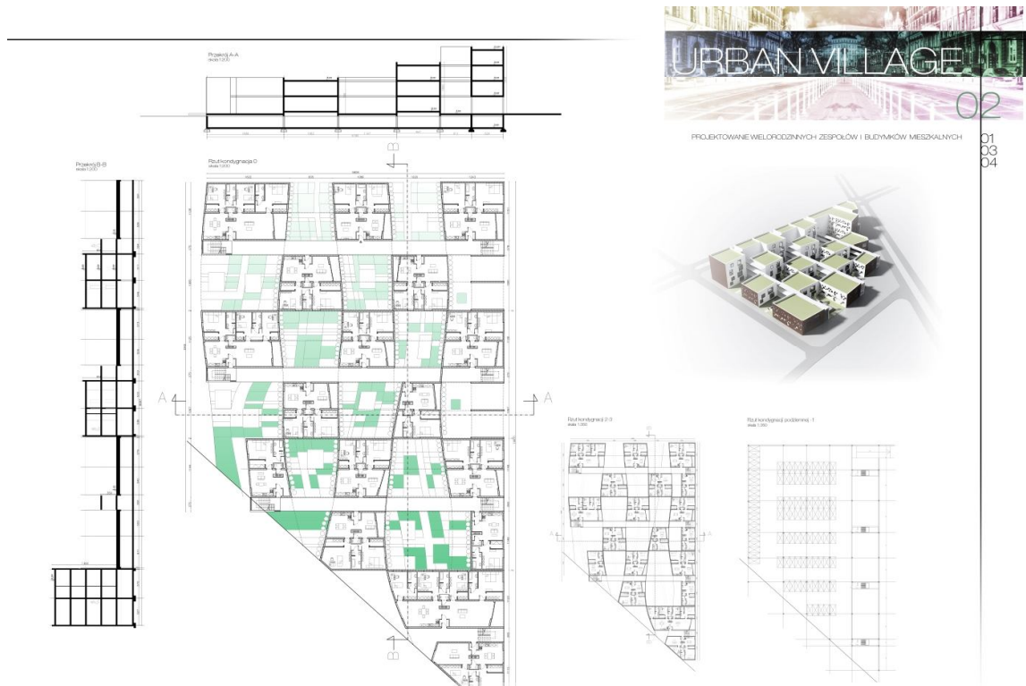
Ryc.12 Inne poszukiwanie pół-intymnej strefy kontaktowej – ogrodów przyporzędowanych niewielkim grupom kilku-rodzinnym – pokazano w projekcie struktury „Urban Village” pani Anny Boreckiej. Dzięki zagęszczeniu tej struktury, z jednoczesnym obniżeniem wysokości zabudowy, uzyskano poszukiwane relacje mieszkanię-ogród. Struktura pokazuje możliwości kształtowania czegoś „pomiędzy” zabudową dywanową jednorodziną a zabudową wielorodzinną. Sądzę że poszukiwania nowych typów, czy typologii, zabudowy wielorodzinnej powinny migrować w tym kierunku: na granicę zabudowy wielorodzinnej z jednorodziną; uzyskiwać komfortowe mieszkania w powiązaniu z kreowaniem niewielkich ogrodów przyporzędowanych mikrospołecznościom.
