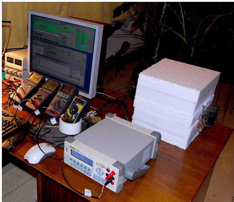
Rys. 3. Stanowisko pomiarowe przewodności cieplnej metali
